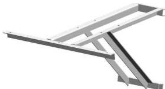
Опорная конструкция трансформатора на железобетонный столб
