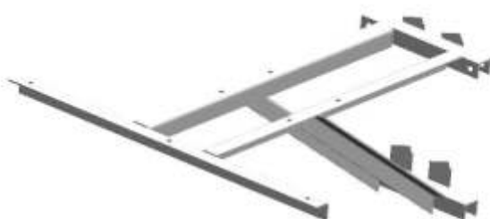
Опорная конструкция трансформатора на поворотный столб
